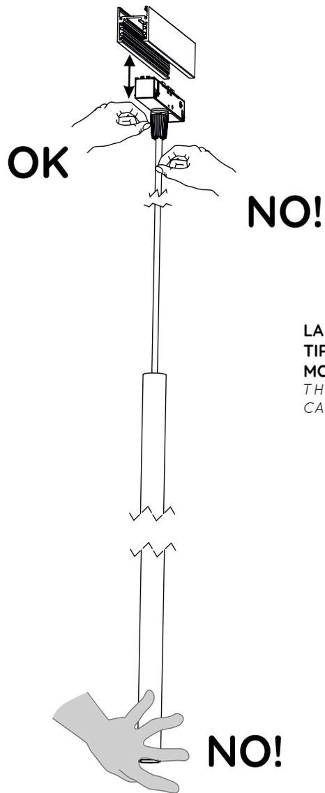
**LA TESTATA DI ALIMENTAZIONE È DI TIPO NON POLARIZZATO E PUÒ ESSERE MONTATO IN ENTRAMBE LE DIREZIONI**
