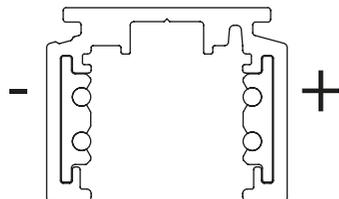
**L'ALIMENTATORE NON POLARIZZATO PUÒ ESSERE MONTATO IN ENTRAMBE LE DIREZIONI**
